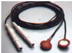
Figura 2 - Eletrodos de Ag-AgCl utilizados na captação do sinal EEG
